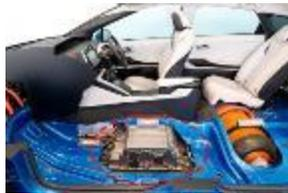
CFRP製 燃料電池フレーム
