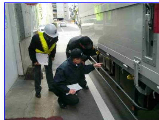
対応2 トラック油漏れ点検 (トヨタ自動車よりの指導による)
